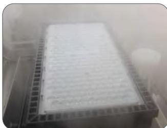
Passato prova di 72 ore spray-salato, che equivale a 3 anni di resistenza alla ruggine in ambiente di mare.
